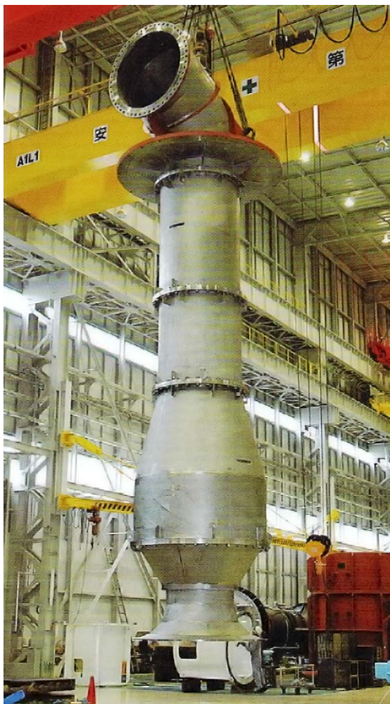
海水に強い特殊ステンレス製の巨大海水ポンプ (写真は富津事業所案内から転写)
