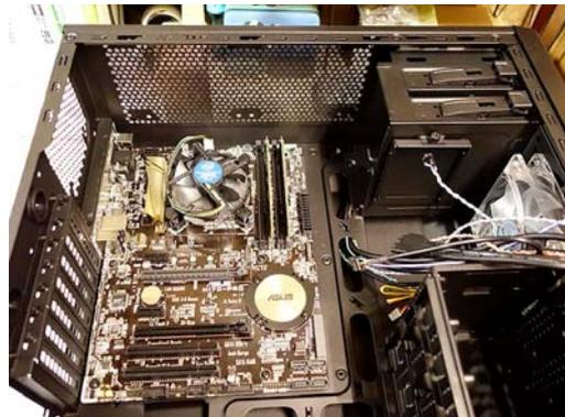
最初にマザーボードを浮かして取り付ける為の、スペーサー・ネジを付けるのを忘れ、取付ネジが短いなどとブツブツ。少し焼きが回ったか？
